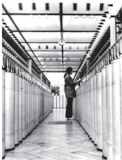
Hala bezvřetenové přádelny s 10 stroji BD 200 [2]
