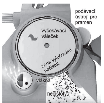
Vylučování nečistot v ojednocovacím ústrojí
