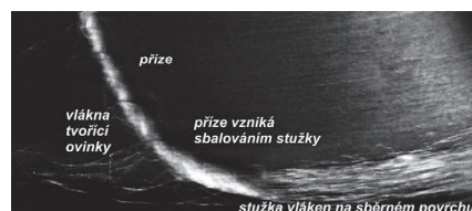
Detail tvorby příze ve spřádacím rotoru [2]
