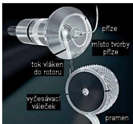
Schéma rotorové spřádací jednotky R36 s vyznačením toku vláken
